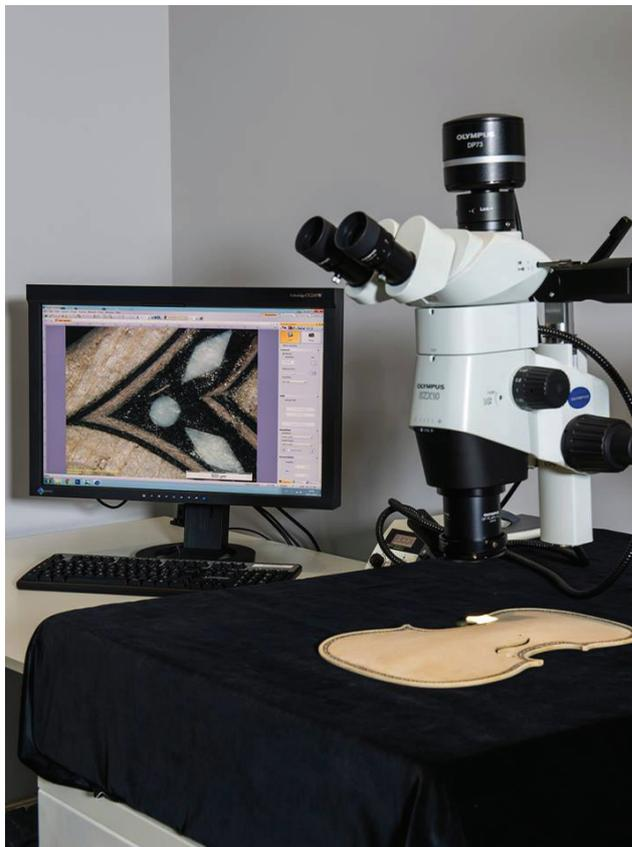
ITA – Il microscopio stereoscopico consente l'osservazione dei dettagli superficiali dello strumento musicale fino ad un ingrandimento di 95X, mettendo in luce fessurazioni, fori di sfarfallamento di insetti xilofagi, craquelures di vernici ed eventuali altre caratteristiche identificative. Una videocamera ad alta risoluzione permette di digitalizzare le immagini e tramite software è possibile effettuare mappature e misure micrometriche di lunghezze ed aree.
